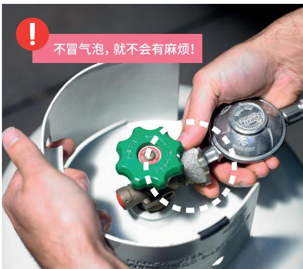
要保证接烧烤BBQ的瓦斯软管未出现磨损现象，所有连接都很紧密。要用肥皂水检查是否漏气。
